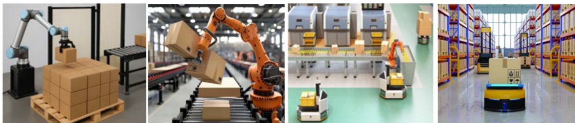
Slika 5. Reprezentativni primjeri naprednih robotskih prihvatnica za sortiranje i paletizaciju paketa. Prikazane konfiguracije uključuju različite mehanizme hvatanja (vakuumske, mehaničke i adaptivne), uz integraciju sa vizuelnim sistemima i softverskom kontrolom u skladu sa zahtjevima Industrije 4.0
