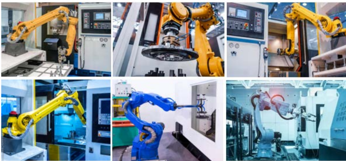
Slika 4. Primjeri implementacije industrijskog robota u opsluživanju CNC alatnih mašina [34-37]
