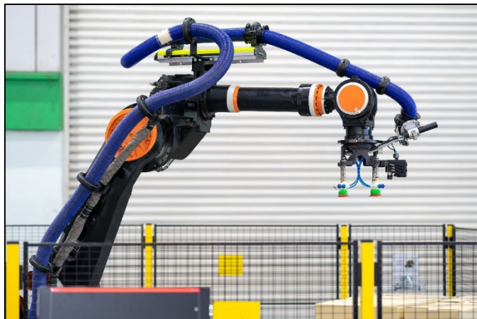
Slika 9. Integrirani AI gripper, Stellarix, koji koristi umjetnu inteligenciju za autonomno prepoznavanje objekata i prilagođavanje strategije hvatanja [40]
