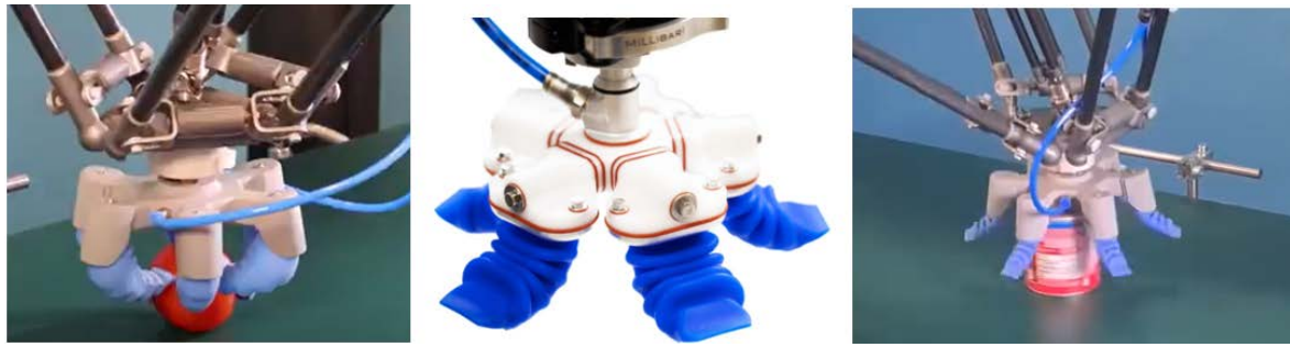
Slika 3. Primjena pametne prihvatnice sa integrisanom 3D vizijom u sistemu sortiranja paketa
