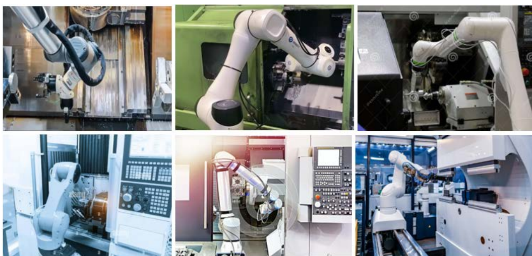
Slika 6. Primjeri implementacije kolaborativnog robota u opsluživanju CNC alatnih mašina [40-42]
