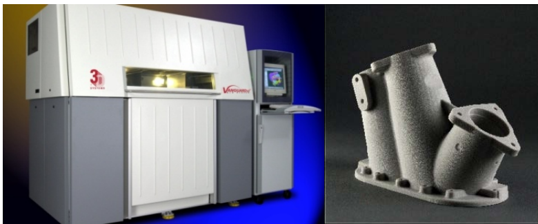
SLIKA 4. Mašina za postupak selektivnog laserskog sinterovanja i primjer izratka
