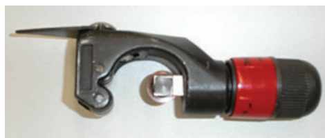
Slika 10.8: Različite vrste alata (“reamer”) za čišćenje deformacije (opiljaka) na mjestu sječenja
