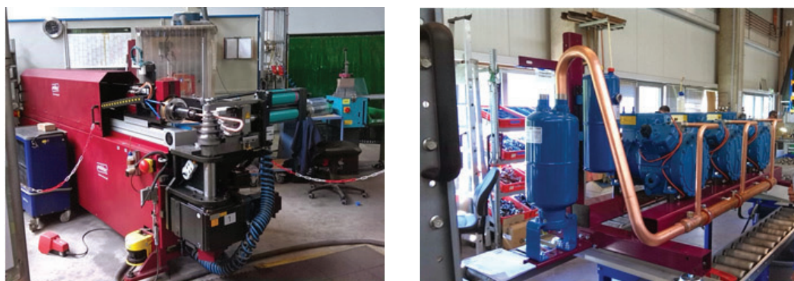
Slika 10.10: Mašinsko savijanje bakarnih cijevi i povezivanje komponenti sistema
