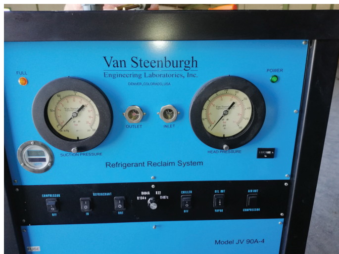
Slika 5.27: Uređaj za regeneraciju malih količina rashladnih fluida
