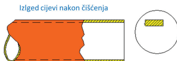
Slika 10.9: Izgled cijevi nakon čišćenja opiljaka
