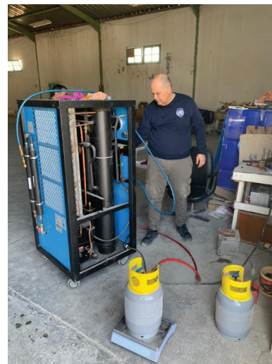
Slika 5.27: Uređaj za regeneraciju malih količina rashladnih fluida
