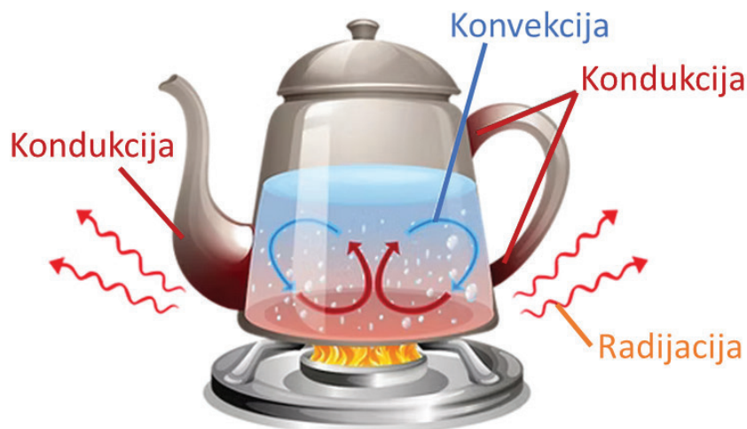
Slika 1.2: Mehanizmi prijenosa toplote
