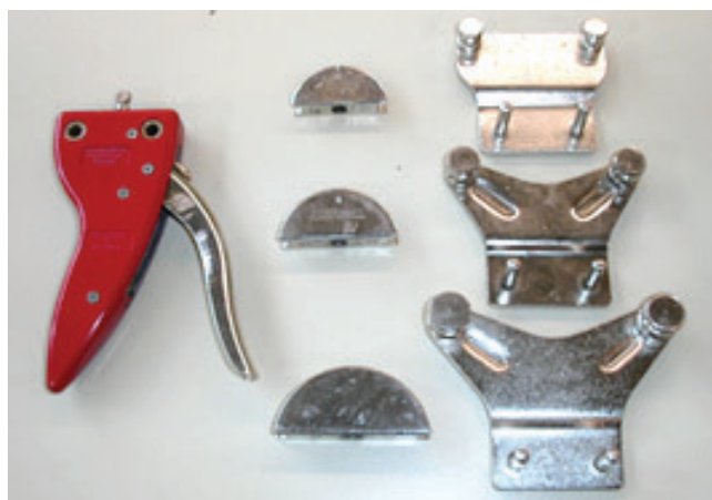
Slika 10.13: Ručni presovni savijač
