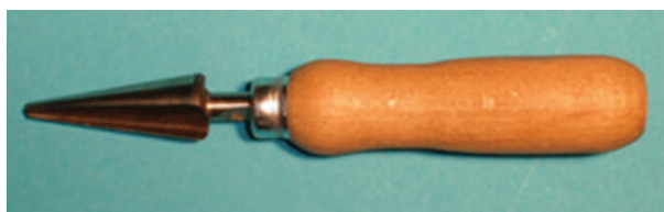
Slika 10.8: Različite vrste alata (“reamer”) za čišćenje deformacije (opiljaka) na mjestu sječenja
