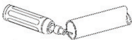
Korak 1: Čišćenje krajeva cijevi od savijanja od rezanja
