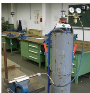
Povezivanje azotnog cilindra
