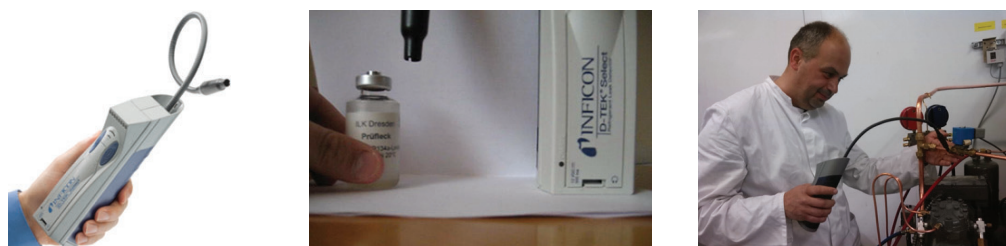
Slika 4.6: Provjera propuštanja korištenjem infracrvenog elektronskog detektora propuštanja
