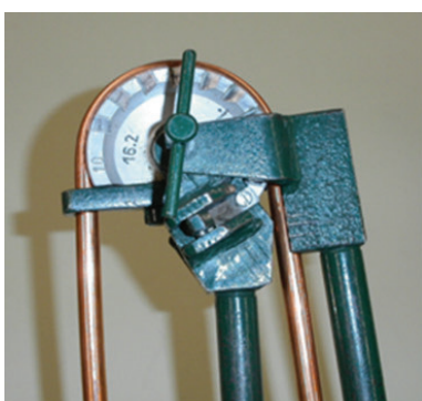
Savijanjem Savijanje pod uglom od 90°
