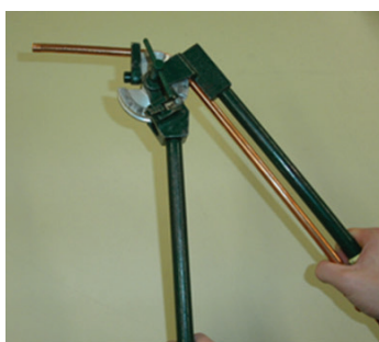
Savijanje pod uglom od 45°
