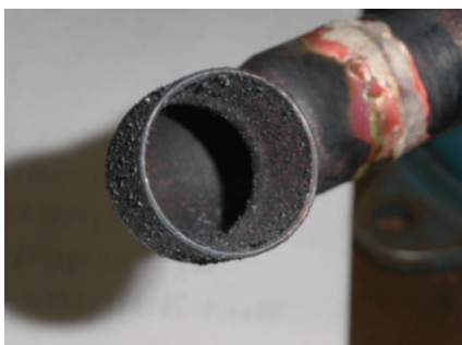
Lemljenje bez korištenja suhog azota
