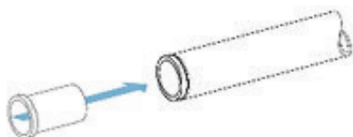
Korak 1: Čišćenje krajeva cijevi od savijanja od rezanja
