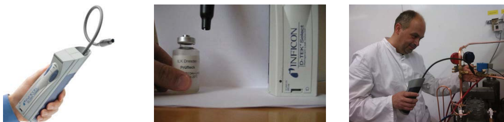
Slika 4.6: Provjera propuštanja korištenjem infracrvenog elektronskog detektora propuštanja
