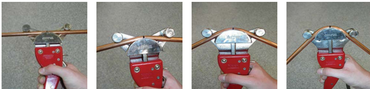
Slika 10.14: Koraci prilikom savijanja cijevi ručnim presovnim savijačom
