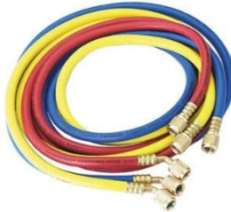
Servisna crijeva sa ili bez ventila i dopunski servisni ventili
