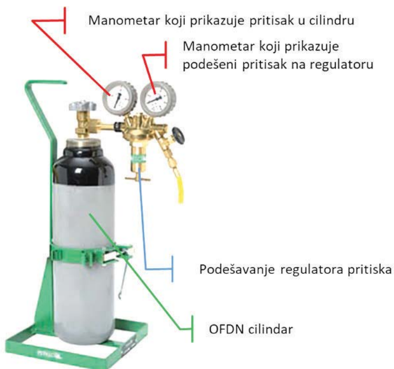
Slika 3.3: Cilindar sa suhim azotom sa regulatorom pritiska koji se koristi za test pod pritiskom
