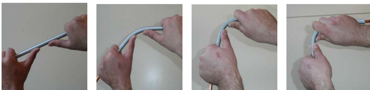
Slika 10.16: Koraci prilikom savijanja cijevi oprugom
