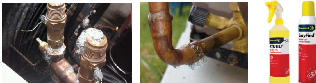
Slika 4.5: Provjera propuštanja korištenjem testa sapunicom i mjehurićima
