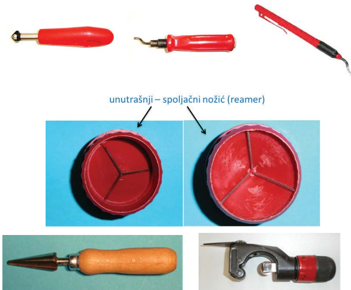
Slika 10.8: Različite vrste alata (“reamer”) za čišćenje deformacije (opiljaka) na mjestu sječenja
