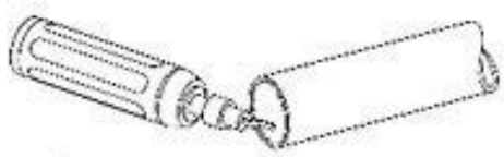
Korak 1: Čišćenje krajeva cijevi od savijanja od rezanja
